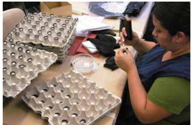
CGR ensambla a mano sus anillos de goma O personalizados en el interior de los anillos de metal O proporcionados por el cliente.
