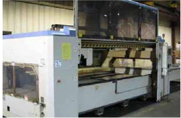
*Un cortador láser utilizado para cortar grandes piezas de chapa de metal.*
