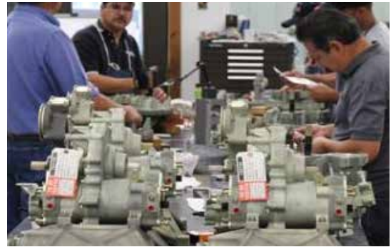
Los miembros del equipo de Thomas Instrument ensamblan y prueban cajas de engranajes.
