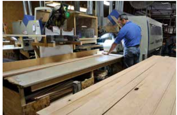
Cepilladoras Weinig con husillos de alta precisión HSK para producir molduras.
