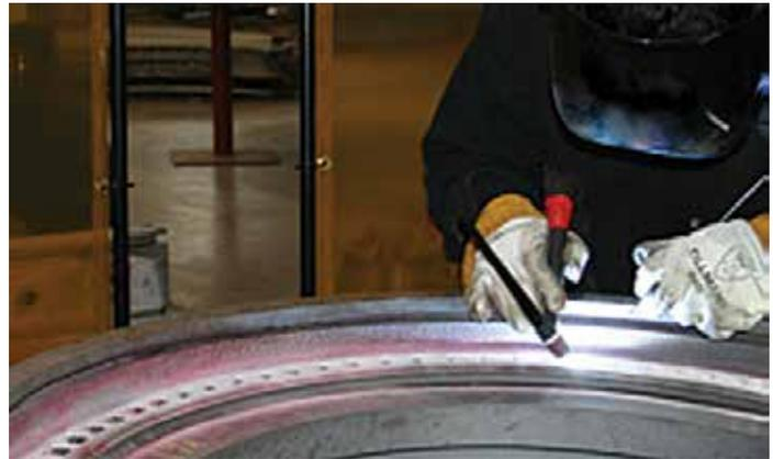
*Un empleado de APG reparando un motor de turbina de gas industrial.*
