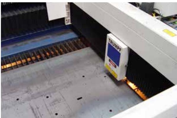
*Láser Trumpf de 4000 vatios para cortar acero al carbono con precisión.*
