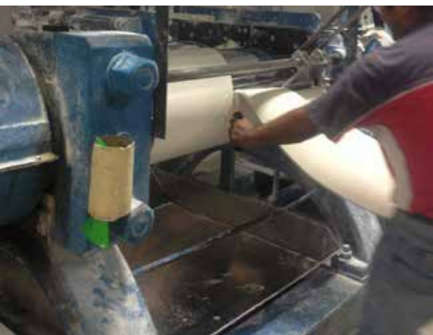
Parte del proceso de mezcla de componentes de caucho en Archer Advanced Rubber
