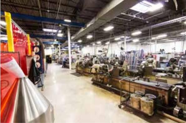
La planta de Auger Fab incluye una variedad de máquinas: 6 fresadoras de rosca, 8 cabinas de soldadura, 10 tornos de motor manuales, 12 máquinas de varios ejes CNC y 3 molinos manuales
