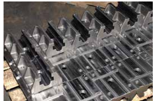
Mordazas de perforación fabricada por H&R a punto de ser completadas en piso
