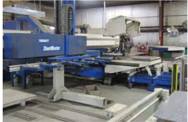
Una combinación de láser y punzonadora Trumpf que corta diferentes formas con el láser y las deposita en bandejas de material separadas.
