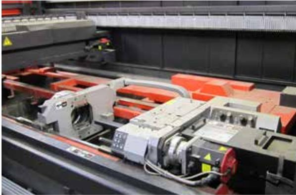
El nuevo láser de 4000 vatios con movimiento rotativo de Zephyr puede trabajar con cualquier lámina plana de hasta 1 pulgada, mientras que el rotativo puede cortar con láser cualquier acero estructural o tubo de hasta 8 pulgadas.
